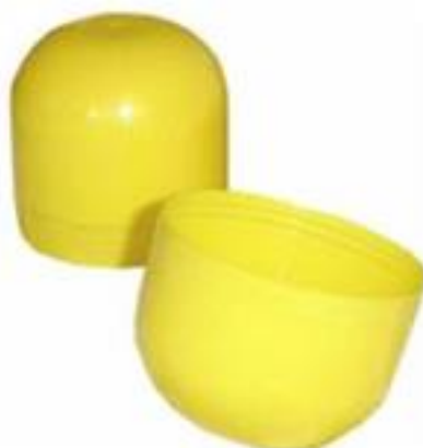
Figura A.7 – Ejemplo de incumplimiento en envases de forma cilíndrica con extremos redondeados
